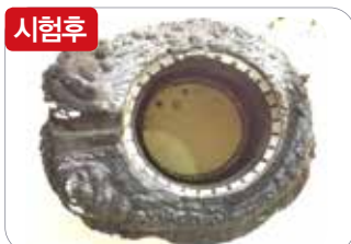
▲ 시험 후의 내부구조, 화염에 전혀 지장이 없는 본 제품
