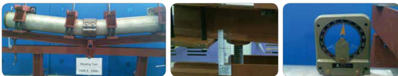
사진 3. 좌우측 각각 2.5° X 2 = 5° 굽힘 변위를 가해 압력 유지 및 굽힘변위량 90mm
