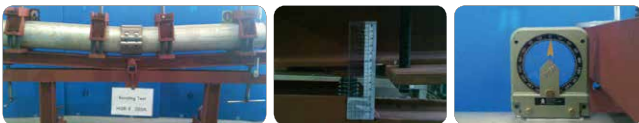
사진 2. 좌우측 각각 1.15° X 2 = 2.3° 굽힘 변위를 가해 압력 유지 및 굽힘변위량 44mm
