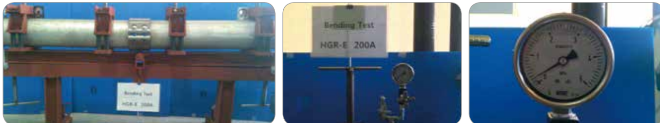
사진 1. HGR-E 200A 카플링에 공기압 0.2Mpa를 가압한 상태
