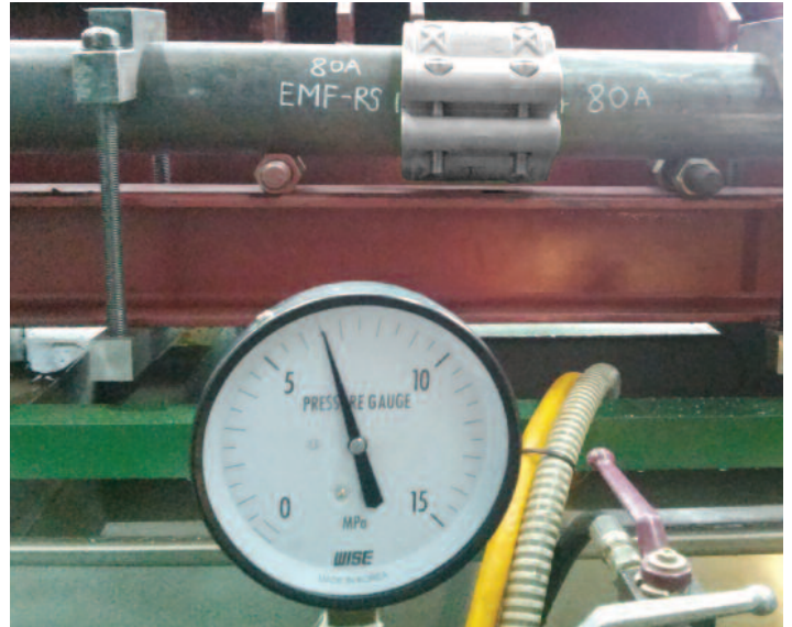
80A 신설배관 압력시험 6.5Mpa (65kgf/cm 2 ) 압력시험 중 : 이상 없음
