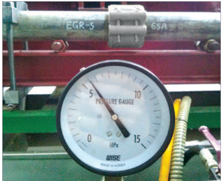
65A 내탈관 시험 5.5Mpa (55kgf/cm 2 ) 압력시험 중 : 이상 없음
